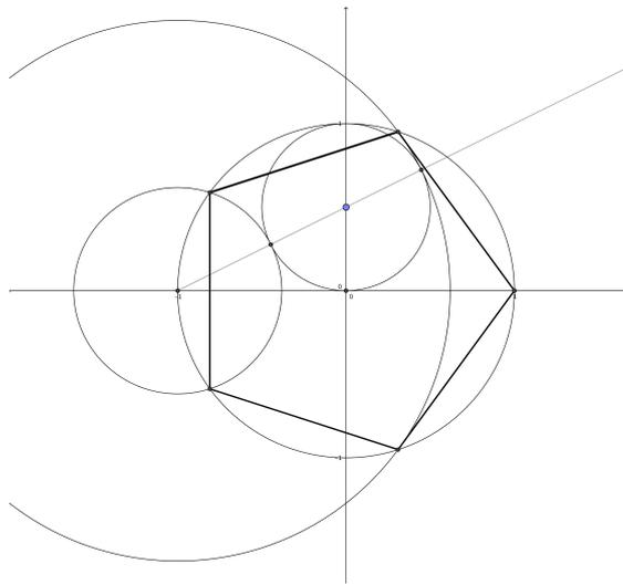
FIGURE 5 – Construction de Duerer du pentagone regulier
