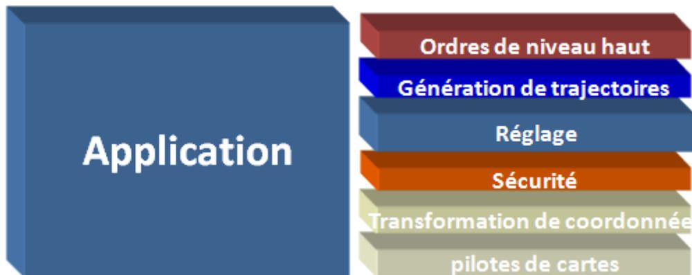
Figure 49, Composantes du logiciel de commande
