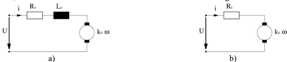
**Fig. 8** Schéma équivalent d'un moteur CC. a) schéma complet, b) schéma simplifié utilisé pratiquement.
