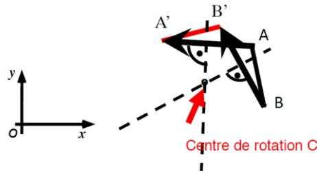
$$2. \mathbf{p} - R\mathbf{p} = \begin{pmatrix} a \\ b \end{pmatrix} \Rightarrow \mathbf{p} = \frac{1}{2(1-\cos(\vartheta))} \left( \begin{pmatrix} a \\ b \end{pmatrix} - R(-\vartheta) \begin{pmatrix} a \\ b \end{pmatrix} \right)$$
