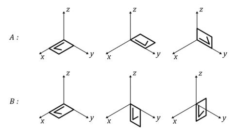
En inspectant les dessins ci-dessus, on remarque que l'objet a le même « aspect » (forme du rectangle après projection à plat) avant et après la transformation. Ceci est une raison nécessaire pour que l'axe de rotation soit orthogonal au plan de la feuille.
