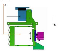
Dans ce cas, il est plus difficile d'exprimer le système en fonction de transfert car nous sommes en présence d'une double entrée, une entrée de commande et une entrée constante liée à la force de gravité. L'équation ci-dessus s'écrit alors :
