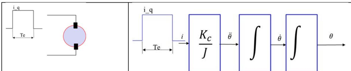
Sachant que le moteur est en boucle ouverte sur une période d'échantillonnage  $T_e$ , le déplacement induit par un courant  $i_q$  correspond à la valeur de la position pour  $t = T_e$ .
