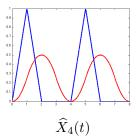
Note: le filtre à moyenne mobile est définie par une intégrale. Il est donc constitué de (morceaux de) *primitives* du signal en entrée: (au plus) des droites si le signal est constant et (au plus) des paraboles si le signal est affine.
