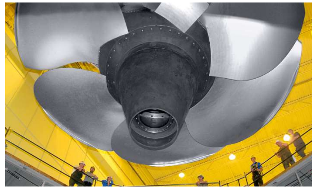
Voith-Kaplan turbine, 200 MW, diameter 10.5m
