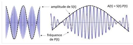
L'onde porteuse est la sinusoïde de haute fréquence tandis que le signal S(t) est rendu visible par l'enveloppe de l'amplitude de la porteuse.
