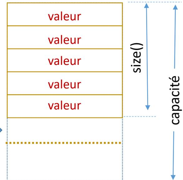
Point faible2: il n'existe PAS de méthode pour ajouter/enlever le premier élément (coté *front*). => Utiliser le **container deque** (double-ended queue). Cet outil permet de mettre en œuvre le concept de *file d'attente* (**queue**).
