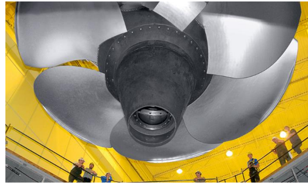
Voith-Kaplan turbine, 200 MW, diameter 10.5m
