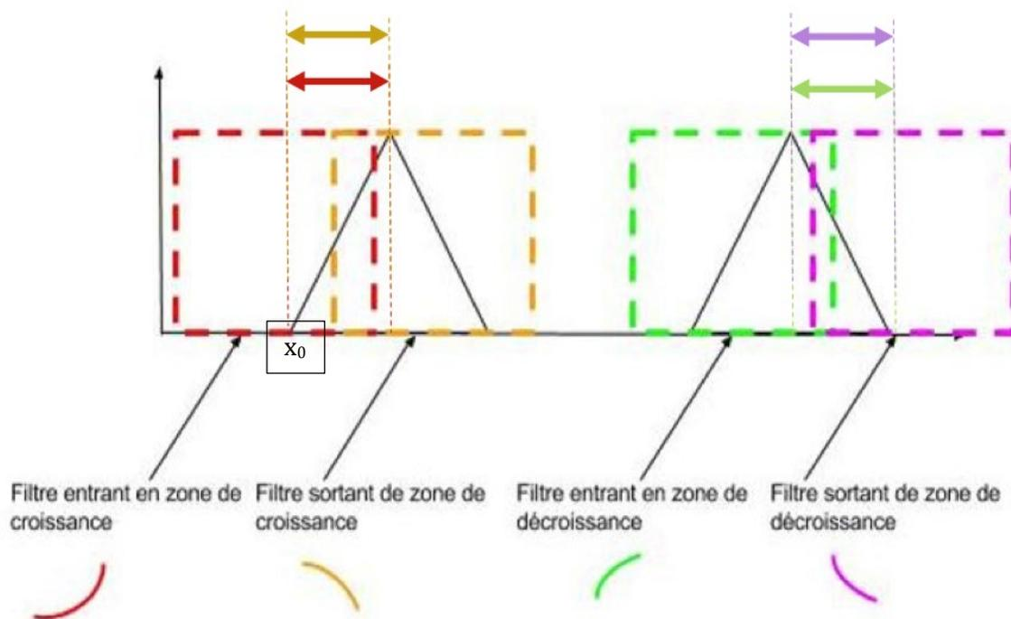
Les doubles flèches  $\leftrightarrow$ , correspondent aux zones où le signal initial est non nul et qui produit un morceau de parabole dont le signe dépend de la position du filtre par rapport au triangle.
