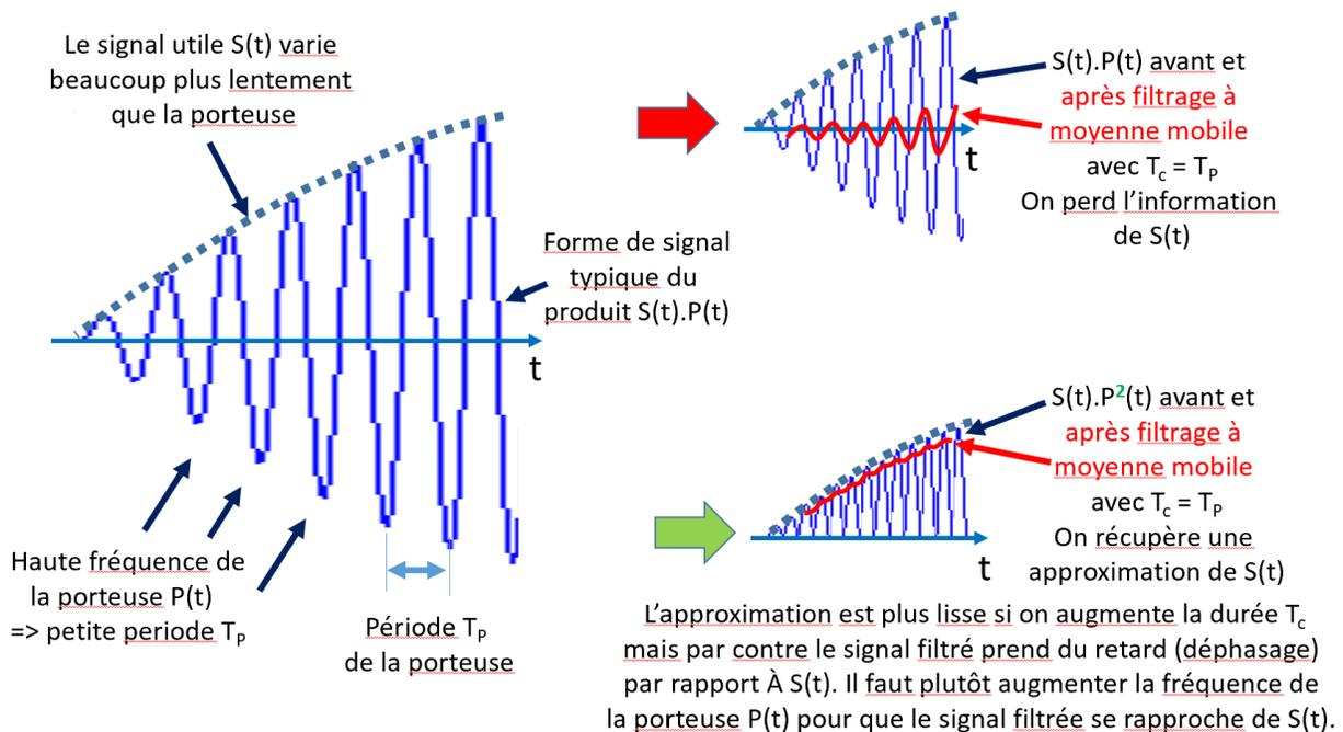
Le dessin du signal filtré (en rouge) est une approximation correcte sur le principe mais elle n'a pas été obtenue avec un outil mathématique ; son amplitude peut légèrement différer de la solution exacte. Dans la réalité la fréquence de la porteuse  $P(t)$  est beaucoup plus grande que dans cette illustration.
