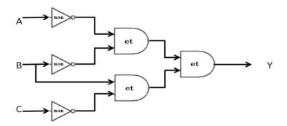
1.2.1 On aurait pu deviner que ce circuit produit toujours une sortie à 0 en observant que l'entrée B <u>et sa négation logique</u> sont impliquées dans des expressions avec seulement <u>des portes AND</u>: la sortie ne peut être que 0 car une porte AND donne 1 seulement si <u>les deux entrées</u> sont à 1.
