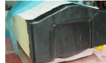
3. Une fois les tissus imprégnés dans le moule ou sur la pièce, le tout peut être mis sous vide pour compacter le composite et évacuer les bulles d'air
