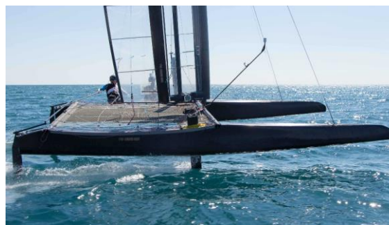
Catamaran Classe C de Hydros.ch réalisé en pré-imprégnés NTPT pour la petite coupe de l'America 2015 Source : decision.ch
