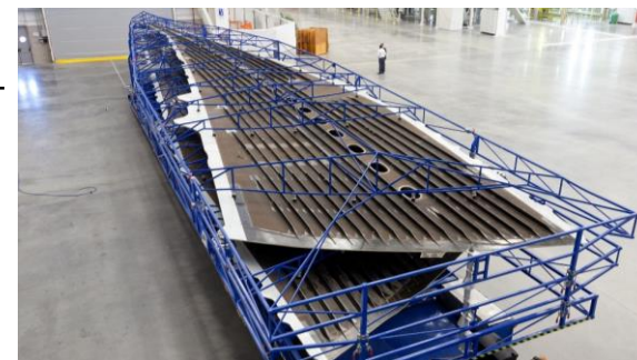
Eléments d'aile de l'Airbus A350XWB fabriqués en carbone pré-imprégné Source : airbus.com
