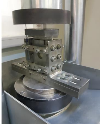
Figure 2: Fixation pour CAI d'après Boeing BSS 7260.
