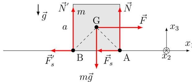
2 points pour 6 forces correctement placées et orientées,  $\vec{F}_S$  et de  $\vec{F}'_S$  doivent être horizontales A,B
