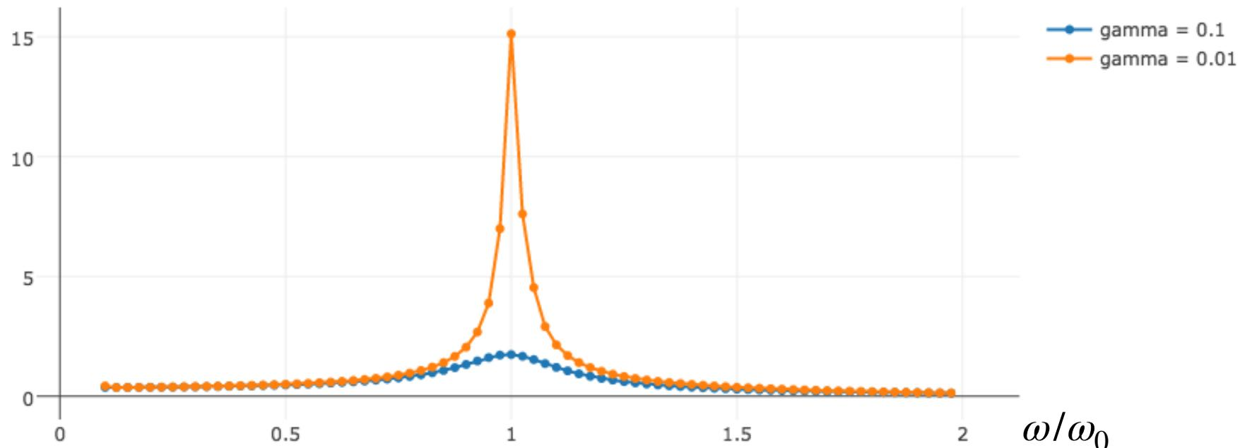
L'amplitude à la résonance augmente quand l'amortissement diminue, pour une amplitude de forçage constante
