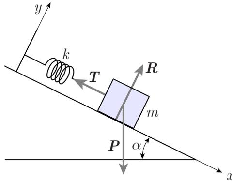
*Référentiel, repère et système* : On choisit comme référentiel le plan incliné et comme repère l'axe de coordonnée  $\mathbf{e}_x$  d'origine  $O$  parallèle au plan incliné dirigé vers le bas et l'axe de coordonnée  $\mathbf{e}_y$  perpendiculaire au plan incliné dirigé vers le haut. Le système est le point matériel de masse  $m$ .
