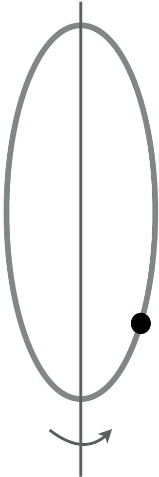
Un point matériel de masse  $m$  peut glisser sans frottement le long d'un anneau circulaire, lui-même en rotation uniforme (vitesse angulaire constante) autour d'un axe verticale passant par son diamètre (voir figure).
