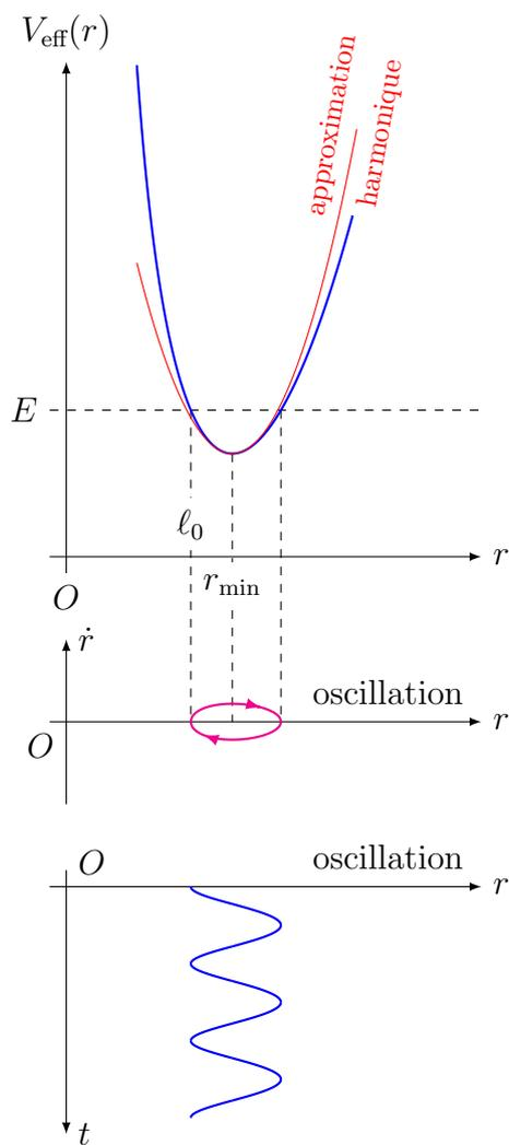
Dans l'approximation harmonique, les fonctions  $r(t)$  et  $\theta(t)$  peuvent être données analytiquement. On obtient la trajectoire ci-dessous dans le plan de la table.
