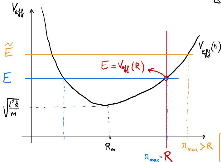
Pour une valeur de  $E$  donnée par les conditions initiales,  $r$  sera borné par  $r_{\min}$  et  $r_{\max}$  correspondant aux points d'intersections entre  $E$  et  $V_{\text{eff}}(r)$
