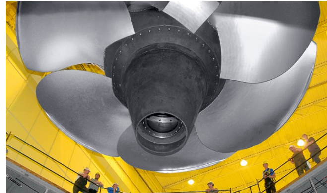
Voith-Kaplan turbine, 200 MW, diameter 10.5m
