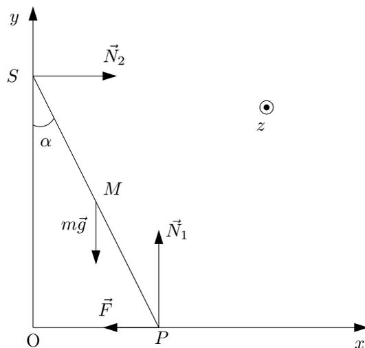
Lorsque  $\alpha < \alpha_{\max}$ , le système est à l'équilibre, la deuxième équation de Newton s'écrit :  $m\vec{g} + \vec{N}_1 + \vec{N}_2 + \vec{F} = 0$ . En projection sur le repère  $Oxy$  du dessin, on a
