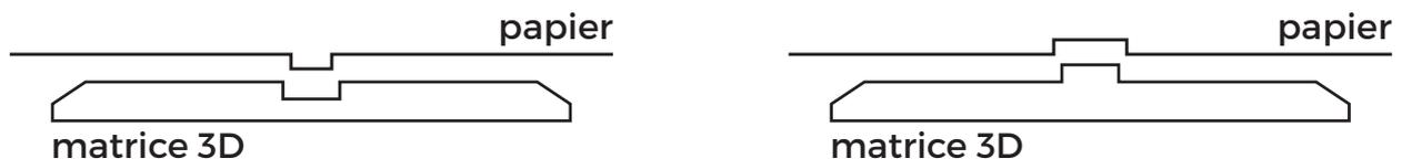
Illustrations en vue de profil d'un gaufrage à partir d'une matrice d'impression
