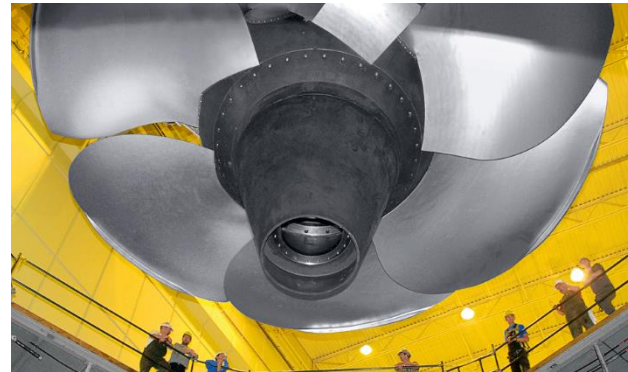
Voith-Kaplan turbine, 200 MW, diameter 10.5m
